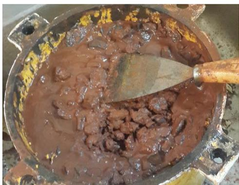
Figura 14. Estado del material de base en los ensayos sin geotextil.
