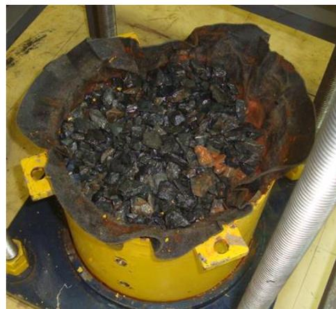
Figura 15. Estado del material de base en los ensayos con geotextil.
