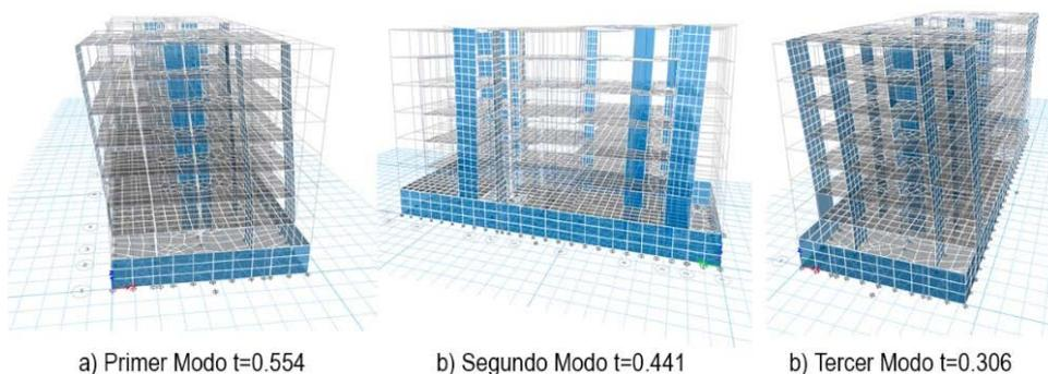
*Figura III.- Modos de vibración de la estructura*
