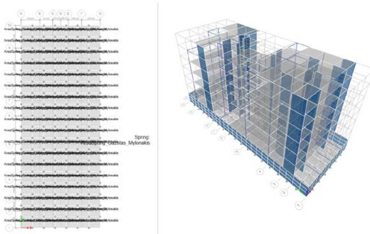
Figura XI.- Modelo con los coeficientes de Gazetas & Mylonakis
