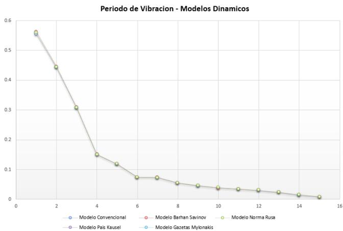
Figura XII.- Periodos obtenidos con el análisis convencional y modelos dinámicos de ISE.
