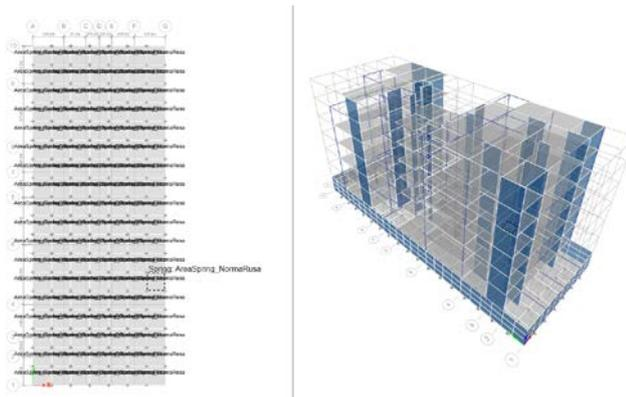
9. *Figura V.- Modelo con los coeficientes de la Norma Rusa*
