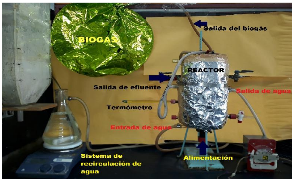
Fig. 2.4. Sistema completo del reactor anaerobio de lecho de lodos de flujo ascendente (RALLFA) instalado en el laboratorio
