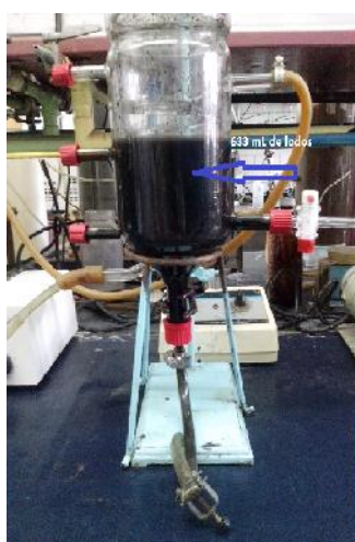
Fig. 2.2. RALLFA a escala de laboratorio instalado (Poblete-Mier, 2015)
