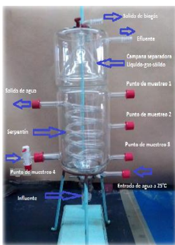
Fig. 2.1. Reactor tipo RALLFA (Poblete-Mier, 2015)
