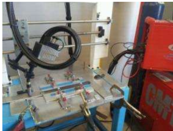
Figura 1. Instalación para posicionar y sostener los cupones, así como para el desplazamiento regulado de la antorcha CMT, diseñada y fabricada por el autor (CIDTS)
