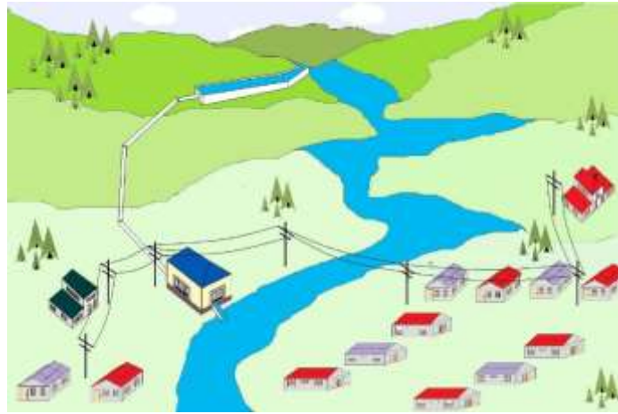
Figura 1. Micro central Hidroeléctrica de pasada o “a filo de agua”. Fuente: elaboración propia, 2019
