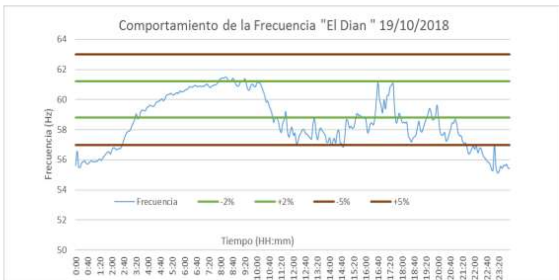
Figura 3. Comportamiento típico de la Frecuencia de una micro-hidroeléctrica sin regulación. Adaptado de (López, 2018)
