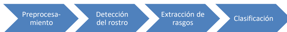
Figura 1. Etapas de un sistema automático de reconocimiento de emociones faciales. Fuente: elaboración propia
