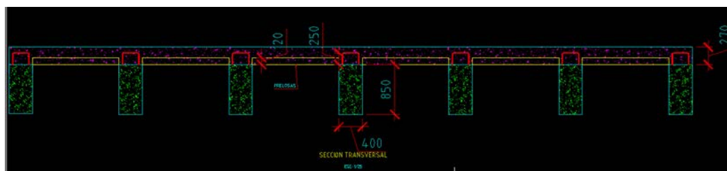
Figura 1.3 Colocación de los cercos para el diseño de puentes nuevos de este tipo.
