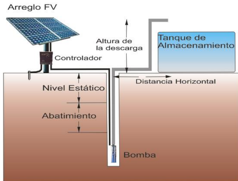
Figura 1. Diagrama de funcionamiento para el bombeo fotovoltaico Tomada del catálogo de bombas (Lorenz 2015)
