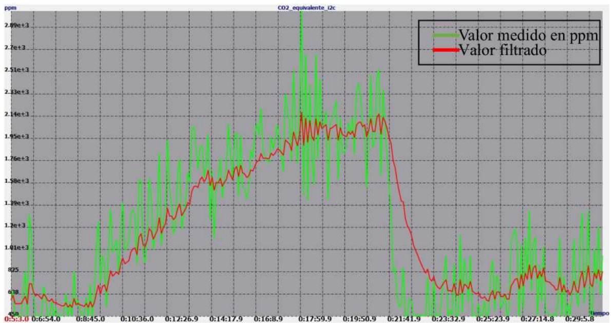
Figura 6. Aumento de la concentración de CO 2 ante la presencia de dicho gas.
