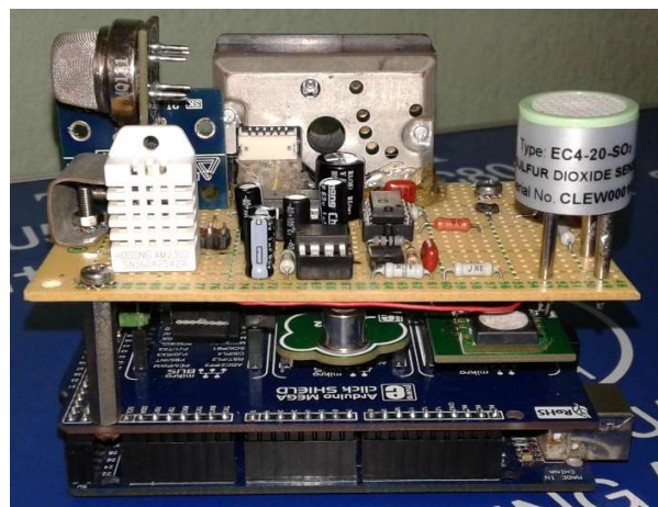
Figura 2. Analizador de gases con sensores de bajo costo.
