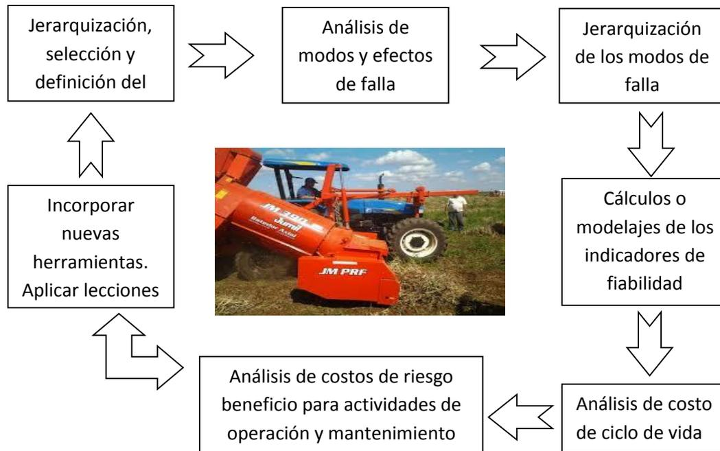
Figura 6. Modelo Integral de fiabilidad de la semicosechadora Jumil 390
