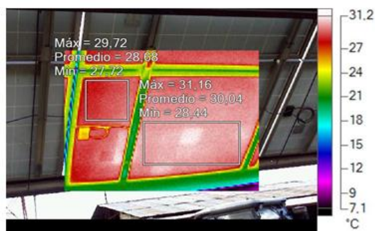
Fig. 9. Termografía con varios HS y distribución variada de temperatura.
