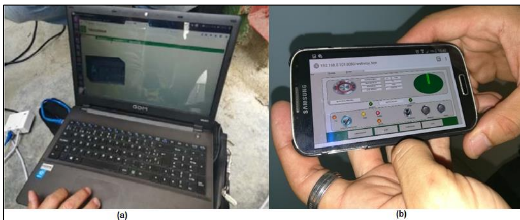
Figura 12 Visualización remota del servidor web durante la segunda prueba experimental de comunicación remota. (a) Sitio web predeterminado del PLC. (b) Sitio web diseñado.
