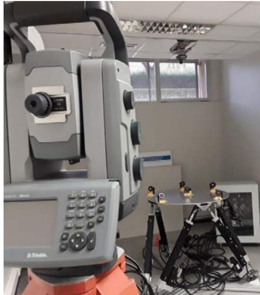
Figura 2. Proceso de calibración de una plataforma Stewart mediante un teodolito
