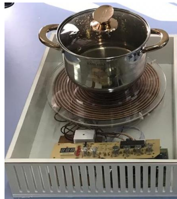
Figura 4. Prototipo de la cocina de inducción en montaje final. Fuente: elaboración propia.
