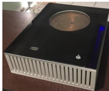
Figura 5. Prototipo de la cocina de inducción finalizada. Fuente: elaboración propia.
