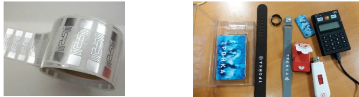
Figura 1: Etiquetas y Lectores RFID (Cortesía de RITE), fotos elaboración propia
