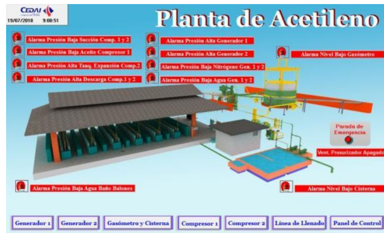
Figura 7. Pantalla principal mostrada al iniciar el SCADA.
