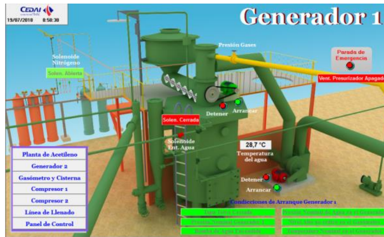
Figura 8. Pantalla que representa el generador y sus componentes.
