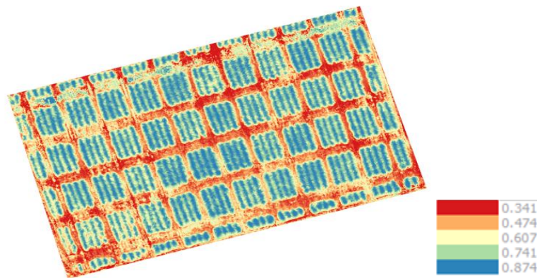
Figura 4. Mapa NDVI a pseudocolor del lote de caña experimental VmNn-18 en la etapa de retoño luego del primer corte. A valores más cercanos de 0.9 mayor vigor vegetal de las plantaciones. Valores cercanos a cero corresponden a suelo descubierto.
