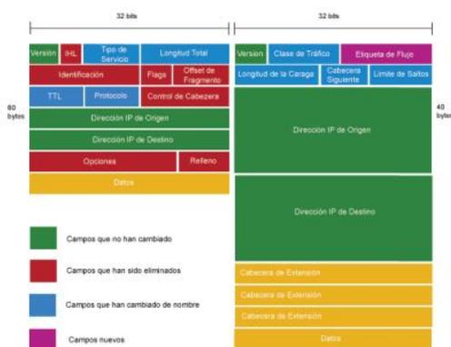
Figura 2 Estructura del paquete IP y las diferencias entre IPv4 e IPv6
