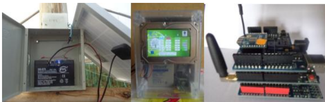
Figura 6. Fotografías de los prototipos de los módulos del sistema inalámbrico: nodo sensor (izquierda), módulo de supervisión-control (centro), módulo de aviso (derecha).
