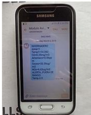
Figura 10. Mensaje recibido por el dispositivo móvil y enviado por el módulo de aviso.
