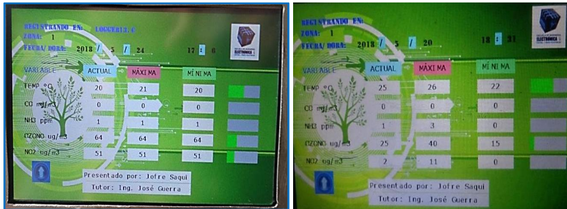
Figura 11. Mediciones obtenidas por el prototipo: ambiente natural (izquierda), ambiente donde se ha aplicado insumos químicos (derecha).
