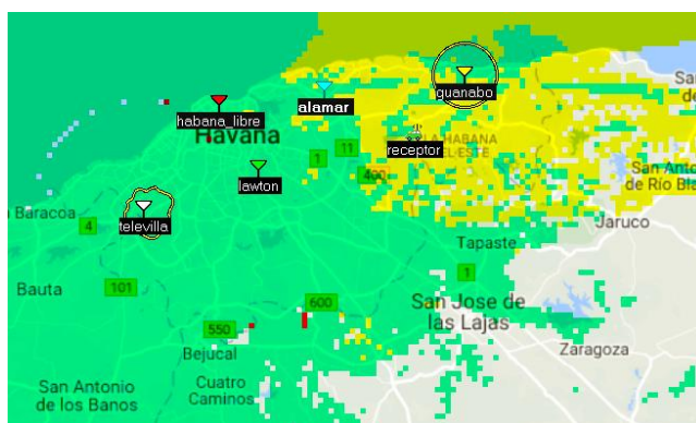
Figura 2: Interferencia entre Televilla y Guanabo retardado 40 \mu s
