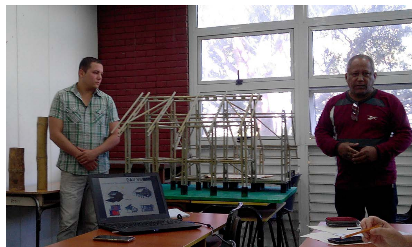
Modelo a escala 1:10 de una cabaña de bambú
