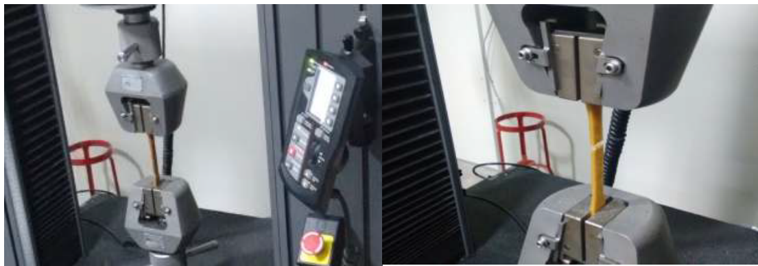
Figura 6: a) Máquina electromecánica universal de ensayo marca INSTRON, modelo 5984: a) en el momento de comienzo de aplicación de la fuerza de tracción, b) En el momento en que el cuerpo de prueba falla
