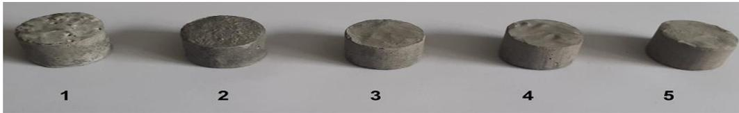
Fig. 5<sup>10</sup>. Segunda etapa del ensayo. Probetas fabricadas de la colada 1 en las 5 fracciones principales
