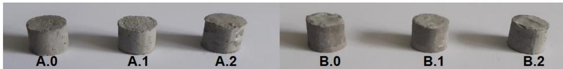
Fig. 4<sup>8</sup>. Primera etapa del ensayo. Probetas fabricadas de la colada 0 hasta 2 (0,1,2) con dos fracciones principales (A,B)
