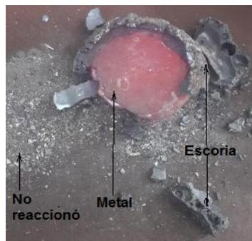
Fig. 2<sup>3</sup>. Productos obtenidos. Metal, escoria y mezcla sin reaccionar
