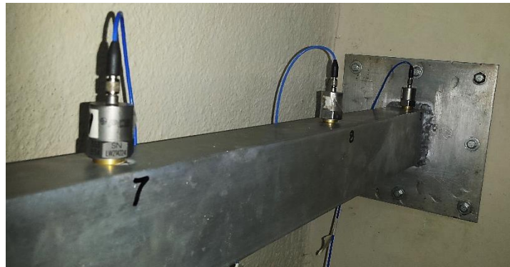
Figura 9 Fijación de la viga a la pared de bloques. Fuente: elaboración propia.
