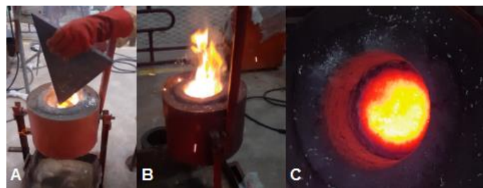
Figura 2.1: Obtención de las termitas. A) Alimentación al reactor e ignición de la reacción, B) Autosostenimiento de la reacción, C) Enfriamiento de la termita (elaboración propia).
