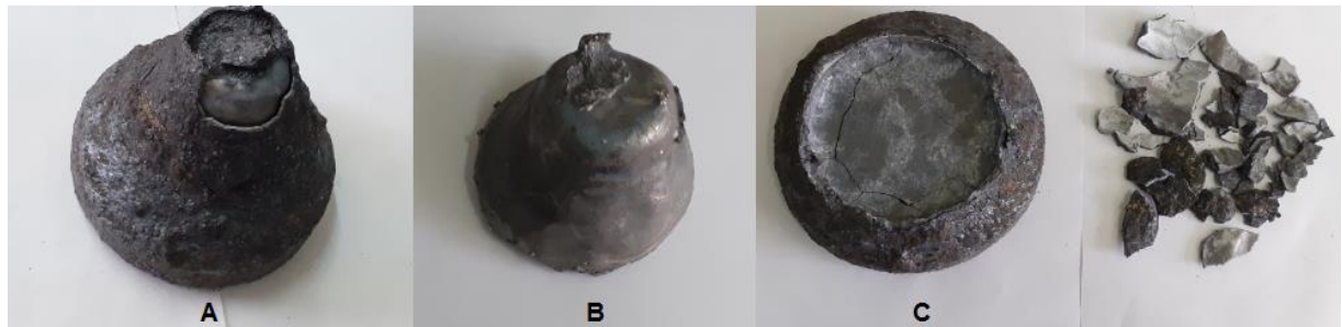
Figura 3.2: Colada grande 1: A) productos obtenidos, B) metal, C) escoria (elaboración propia).
