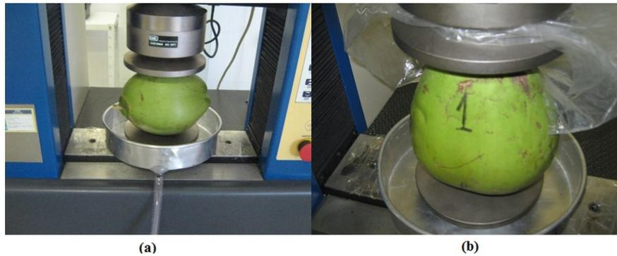
Fig.1. Ensayos de compresión; (a) ensayo horizontal; (b) ensayo vertical.
