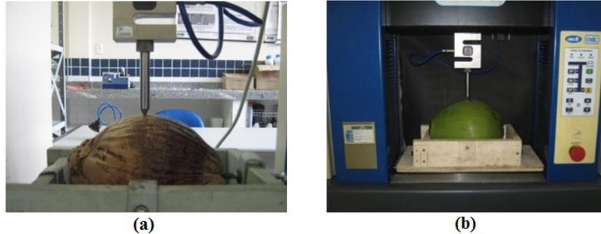
Fig.3. Ensayo de penetración; (a) Coco seco; (b) Coco verde.
