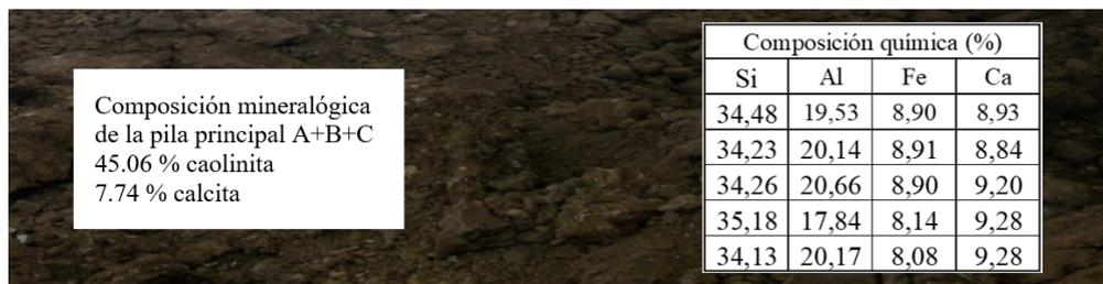
Figura 2: Composición mineralógica y química del material mezclado y homogeneizado. (Fuente: Elaboración propia)
