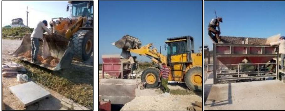
*Figura 3.2. Mezclado de las materias primas.*
