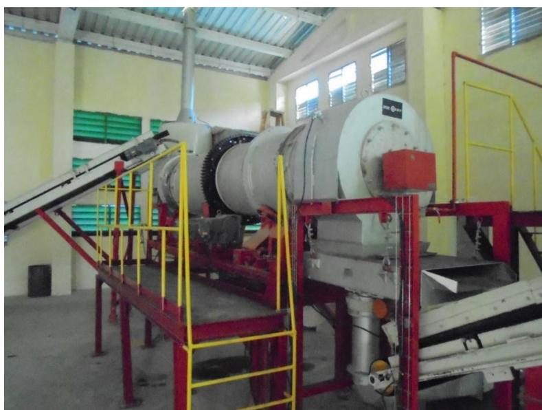
Figura 1. Instalación del horno rotatorio para la obtención de AAT, en detalles quemador e instalación de enfriamiento y evacuación de gases calientes.
