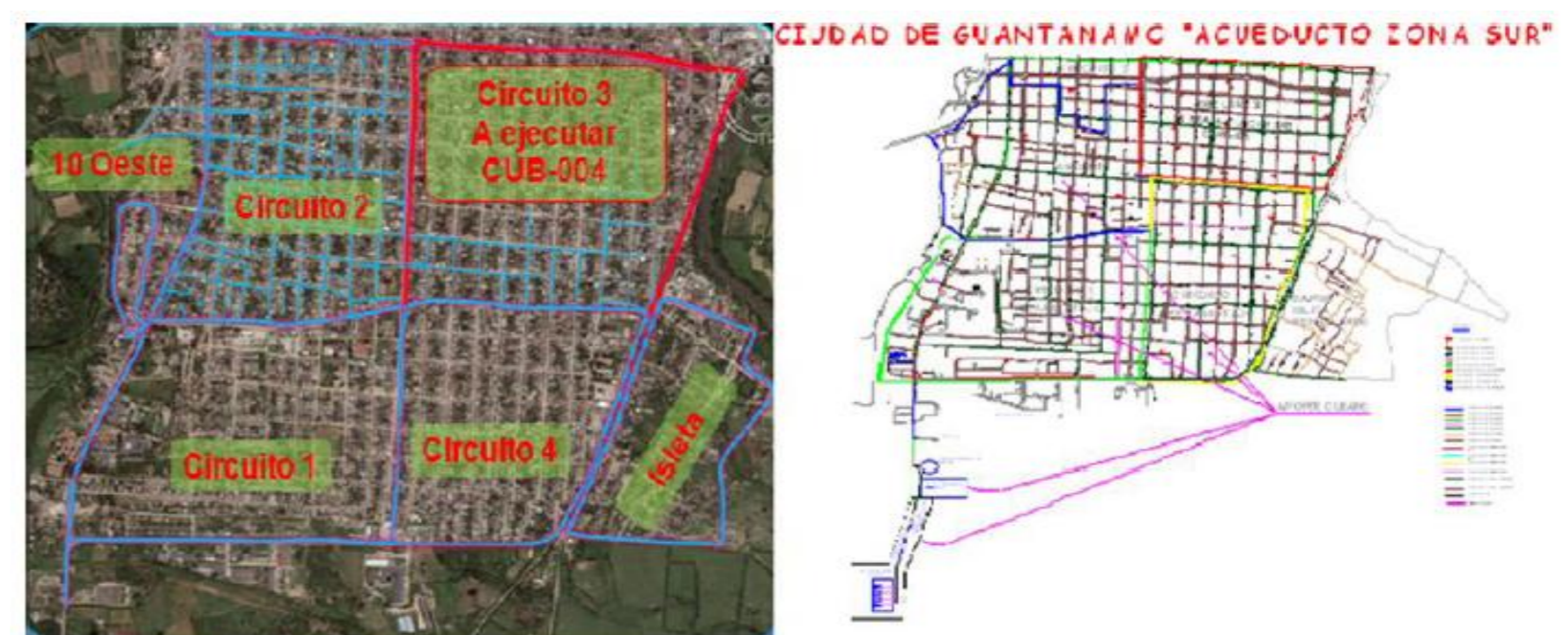
Plano de ubicación del sector hidrométrico Zona Sur Guantánamo, circuitos #1 y 4. Fuente: Hernández, (2018).
