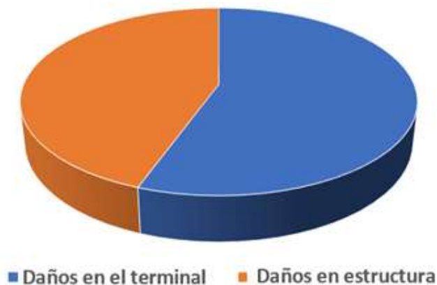
Fig. 4. Tipos de incidencia identificados: Daños en la estructura atribuibles a rayos de baja intensidad y daños en el terminal captador, atribuibles a rayos de elevada magnitud. Fuente: elaboración propia.
