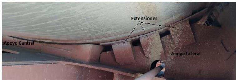
Figura 2.5 Apoyos inferiores en los extremos de la cisterna. Fuente: elaboración propia
