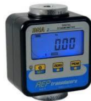
Figura 11: Sensor de fuerza digital (Ibarra Páez, 2022).
