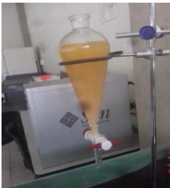
Figura 1. Primer lavado de biodiesel. Fuente Manual de biodiesel
