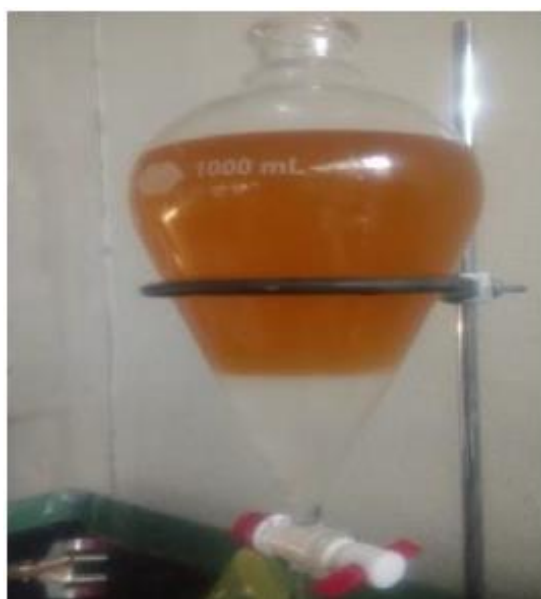
Figura 2 Biodiesel en su último lavado sin impurezas. Fuente Manual de biodiesel
